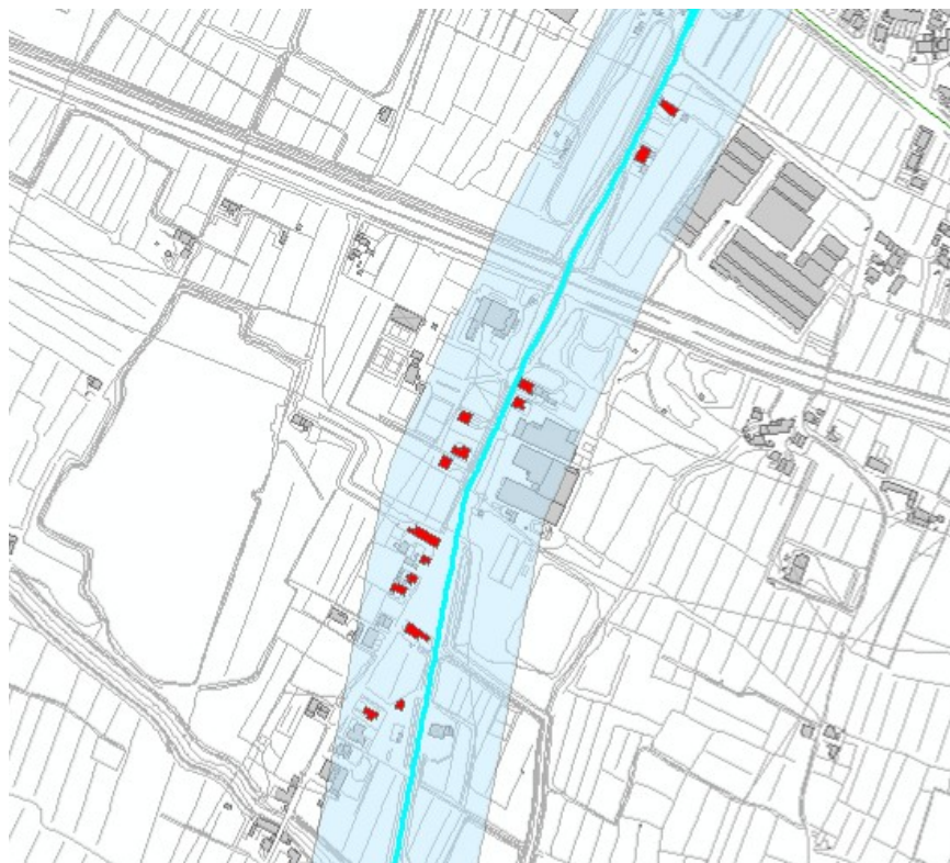
Figura 4.2.1 SP.06 Area di criticità 1- Tratto da Agliana (confluenza con SP1) al confine di Quarrata di 1 km con evidenziati in rosso edifici critici
